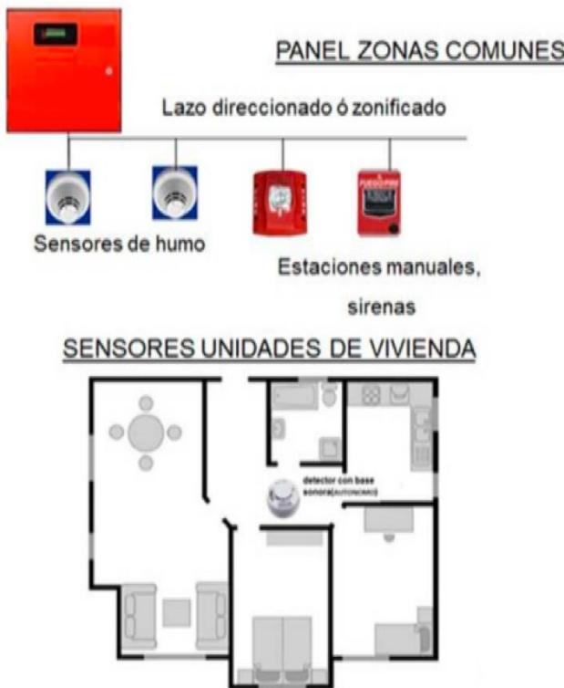
De acuerdo con la NSR-10, se debe contar con dispositivos de anunciación y notificación en cada piso de cada torre, por tal razón, en cada uno de los pisos de las torres que componen las etapas del proyecto, el residente contará con un detector óptico térmico y una sirena estroboscópica.
